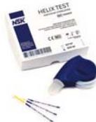
Vorrichtung zur Überprüfung der Dampfdurchdringung im Hohlraum des Handstücks.
